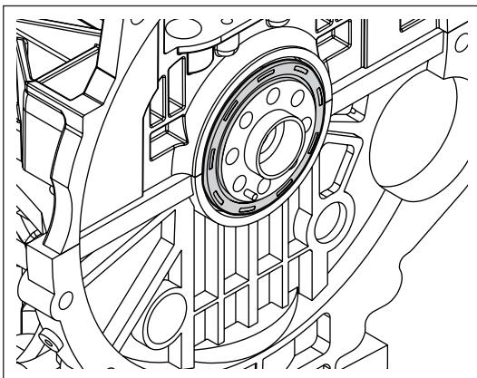
(c). 使用“一字”螺丝刀将曲轴后油封撬出。
