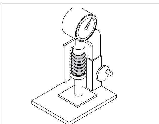
(c). 使用弹簧测力计测量弹簧在标准压缩长度下的弹力，若不符合规定则更换。
