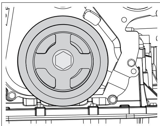
(h). 拆卸曲轴皮带轮固定螺栓。
