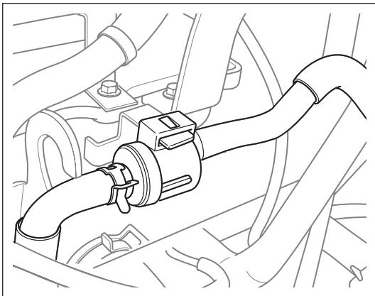
12. 断开碳罐电磁阀连接软管
