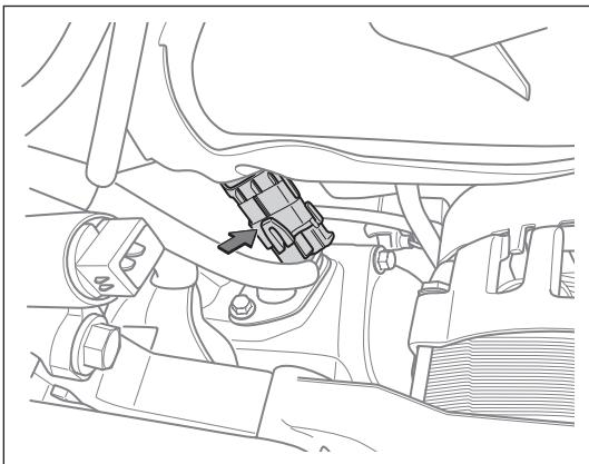
(g). 断开进气压力温度传感器线束接插件。
