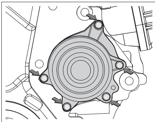
(g). 拆卸水泵固定螺栓，取下水泵以及密封圈。
