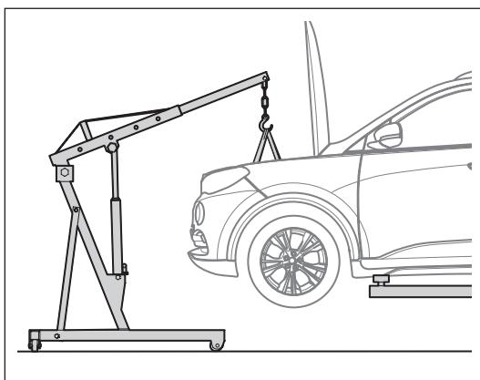
**18. 使用发动机吊装工具吊住发动机****● 提示:**
