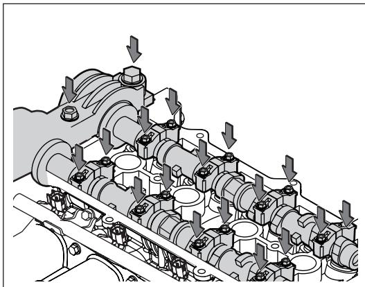
(b). 拆卸凸轮轴盖螺栓，取下所有凸轮轴盖。
