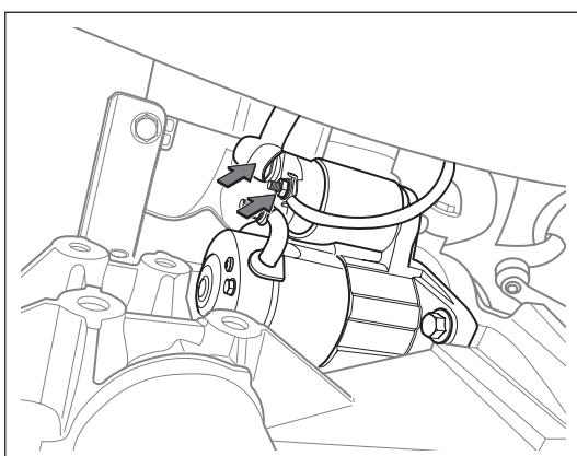
22. 拆卸起动机固定螺栓，取下起动机总成
