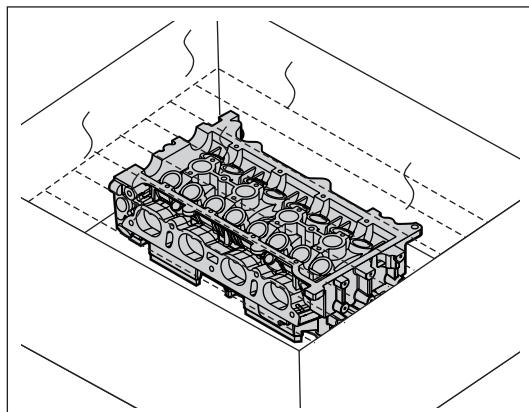
(e). 将气缸盖加热到 80~100°C。
