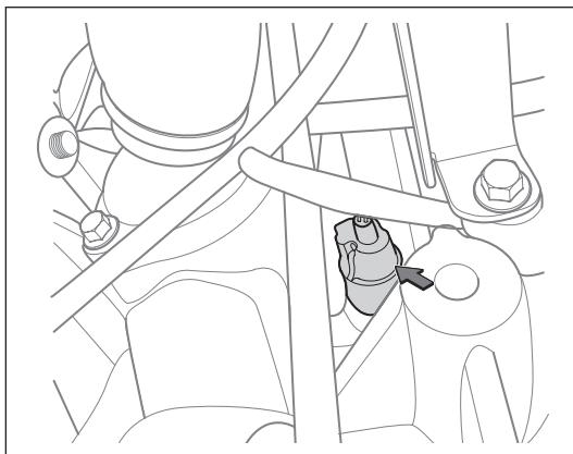
(n). 断开机油压力传感器线束接插件。
