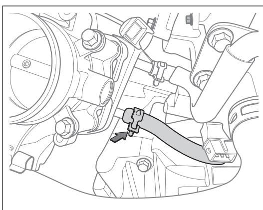
(c). 拆卸真空助力器软管。
