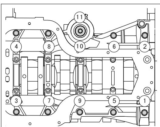
(e). 按如图所示顺序拆卸气缸上、下体固定螺栓。
