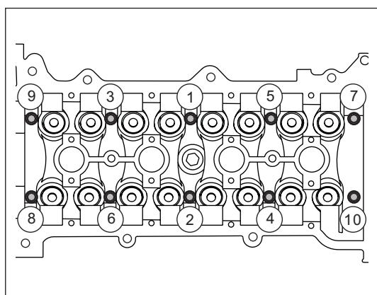
(a). 安装气缸盖到气缸体上, 装上气缸盖螺栓并紧固。
