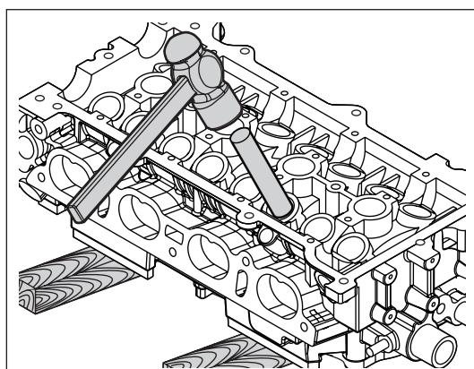
(f). 将气缸盖放在木板上, 使用气门导管拆卸工具将气门导管从气缸盖上取出。
