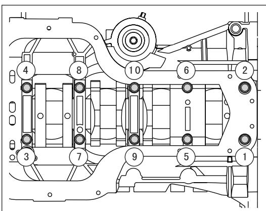
(d). 按如图所示顺序拆卸气缸体主轴承盖紧固螺栓。
