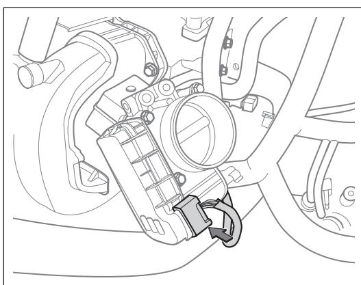
(b). 断开节气门位置传感器线束接插件。
