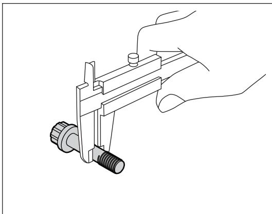
**12. 检查连杆螺栓直径**
