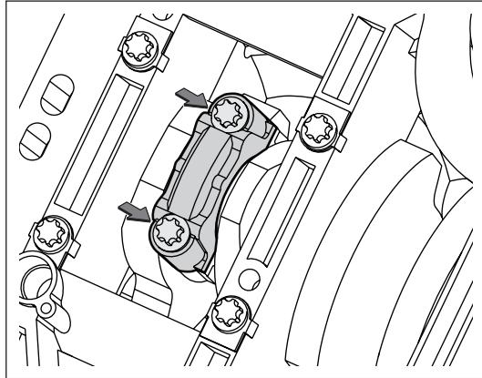
(b). 拆卸机油泵安装螺栓, 取下机油泵以及机油泵垫片。
