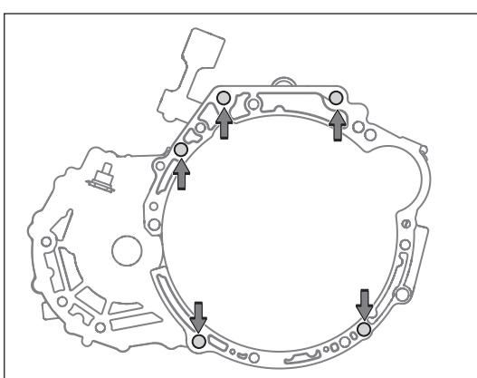
23. 拆卸变速器总成
