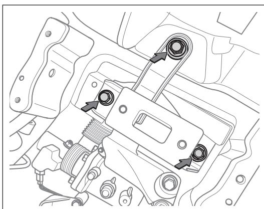
**19. 拆卸变速器悬置固定螺栓****● 提示:**
