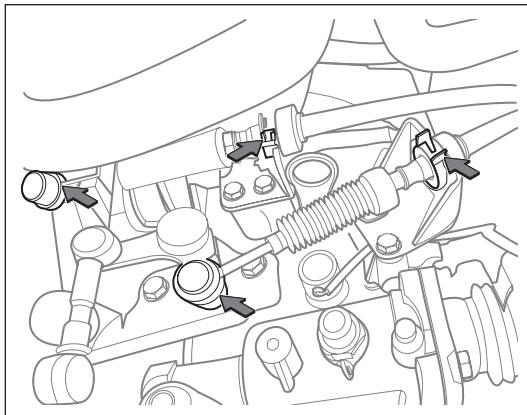
**16. 断开变速器选换挡拉线与变速器的连接**
