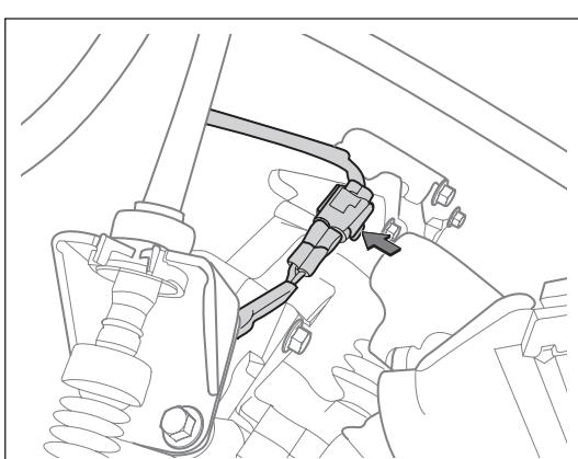
(m). 断开倒挡开关线束接插件。
