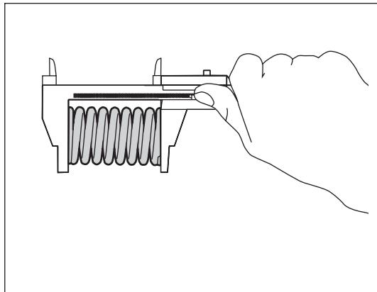
(b). 使用游标卡尺测量自由状态下气门弹簧的长度，若不符合规定则更换。
