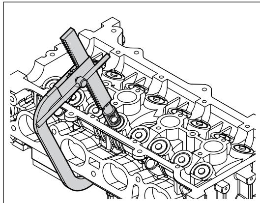
(c). 使用专用工具拆卸气门锁片。
