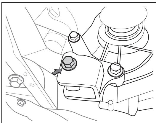
**17. 拆卸扭力臂悬置固定螺栓**
