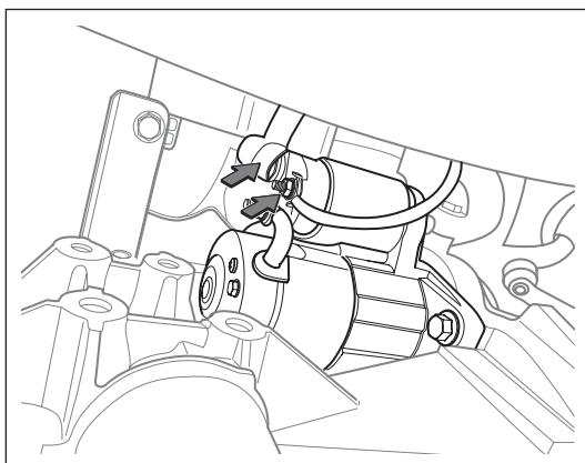
(o). 断开起动机正极接线及起动机接插件。
