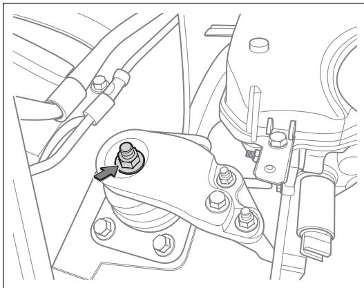
20. 拆卸发动机悬置固定螺母
