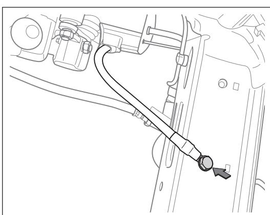
(l). 断开变速器搭铁。
