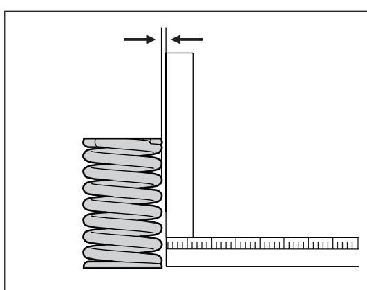
(d). 利用直尺和平板，根据气门弹簧端部和直尺之间的间隙，检查各弹簧的垂直度，如果超出规定值则更换。
