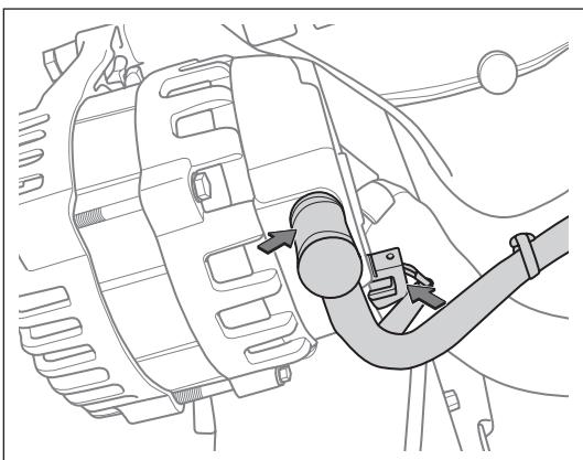
(i). 断开发电机正极接线及发电机接插件。
