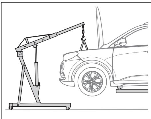
21. 将发动机线束移至一边，慢慢下降车辆或举升发动机吊装工具，将发动机吊出
