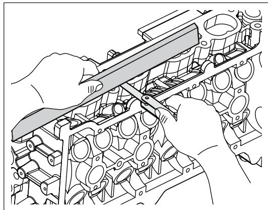
(f). 用直尺和厚薄规检查气缸盖结合面以及进排气侧的平面度。如果平面度超过最大值, 则需更换气缸盖。
